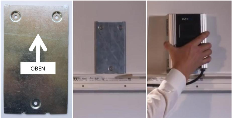
Zur Befestigung an der Wandhalterung ist der AC•THOR mit den beiden Langlöchern an der Oberseite in die Wandhalterung einzuhängen und anschließend mittels Verriegelung an der Unterseite zu fixieren (nach links schieben).
